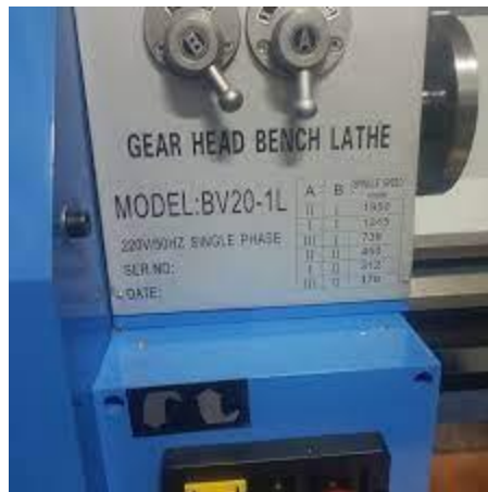
Gambar 2.6 Tuas Pengatur Kecepatan Sumbu Utama dan Plat
