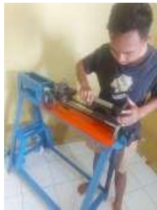
Gambar 4.12 Pemasangan sumbu xy
