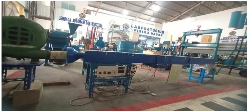
Gambar 3.5 Saluran udara segiempat
