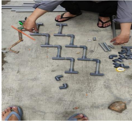
Proses Merakit Pipa Menjadi Media Hidroponik
