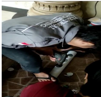
Proses Membuat Lubang Pada Pipa Untuk Netpot
