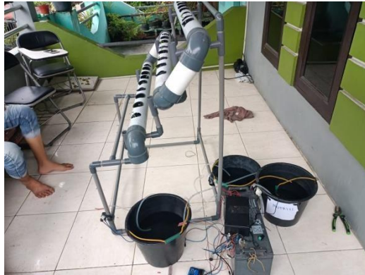
Media Hidroponik Dengan Instalasi Pompa DC
