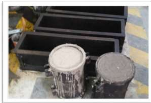
Gambar L-5: Cetakan Beton Silinder dan Balok
