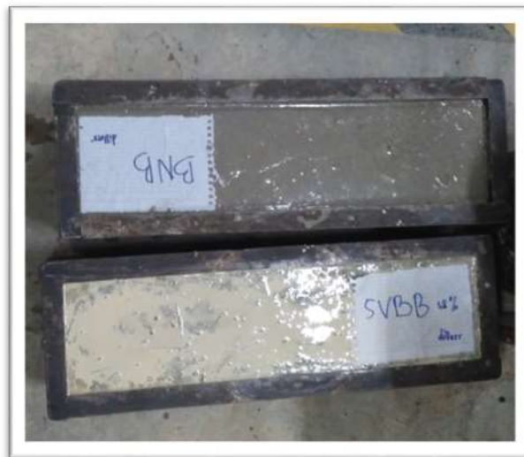
Gambar L-8: Pencetakan Beton Balok
