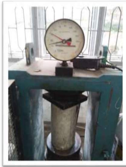
Gambar L-7: Pengujian Kuat Tekan Beton
