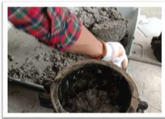
Gambar L-4: Pencetakan Beton Silinder
