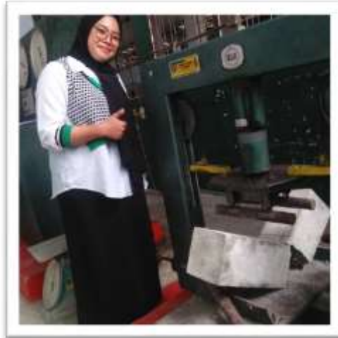
Gambar L-10: Pengujian Kuat Lentur Balok
