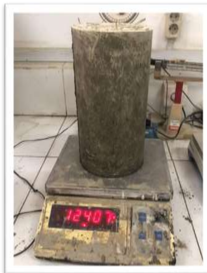
Gambar L-6: Penimbangan Benda Uji Sebelum Pengujian Kuat Tekan
