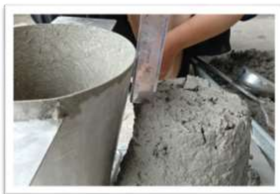
Gambar L-3: Menghitung Nilai Slump
