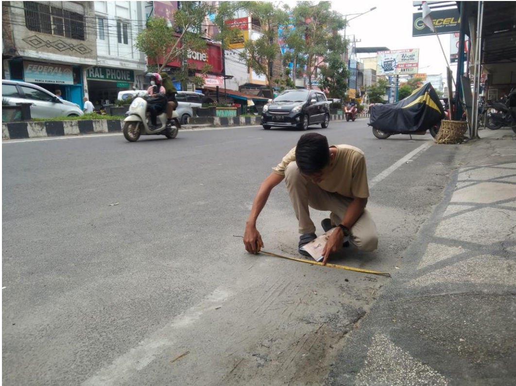
Gambar L.3 : Mengukur lebar badan jalan
