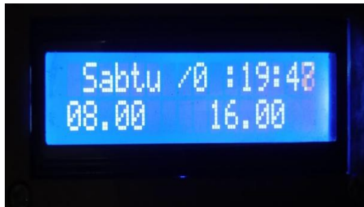
Gambar 4.18 Hasil Pengujian RTC Pada Tampilan Layar LCD
