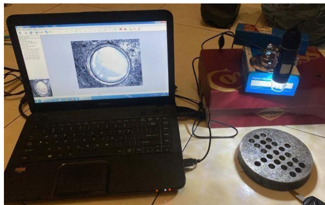
Gambar 4.7 Proses uji kebulatan
