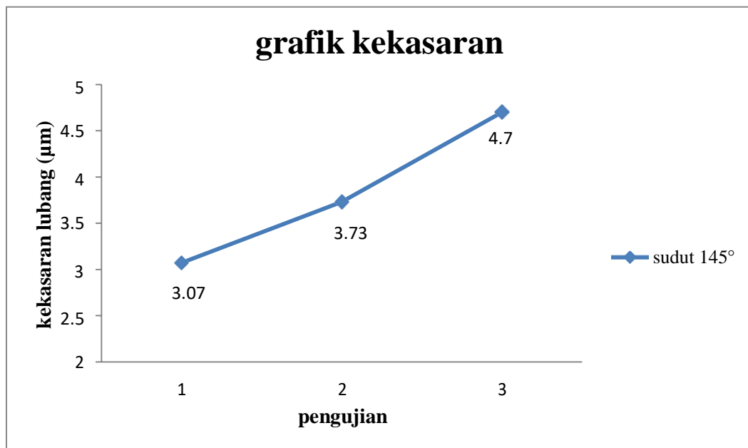
Gambar 4.11 grafik kekasaran pada sudut twist drill 145^\circ
