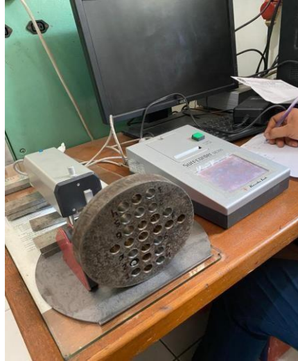
Gambar 4.6 Proses pengukuran kekasaran
