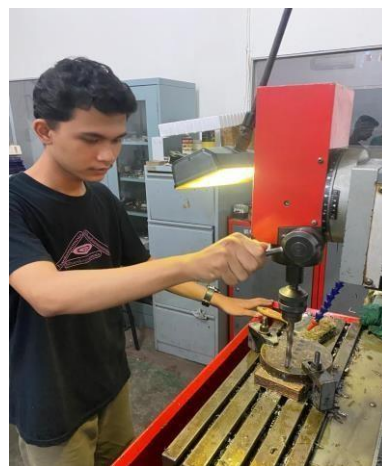
Gambar 4.5 melakukan pengeboran pada spesimen
