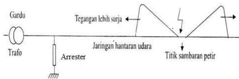
Gambar 2.4 Tegangan surja (lightning surge) akibat sambaran petir
