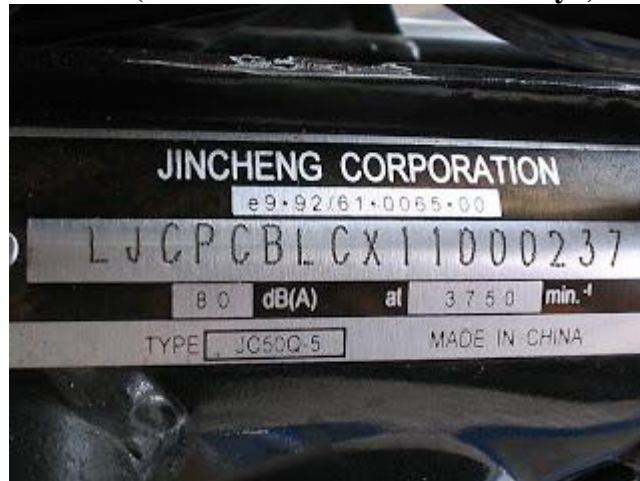
Gambar 1 System penomoran Nomor Identifikasi Kendaraan (NIK)/ Vehicle Identification Number (VIN) sesuai Standar Nasional Indonesia tentang Nomor Identifikasi Kendaraan bermotor (SNI.09-1411-1989 atau revisinya)
