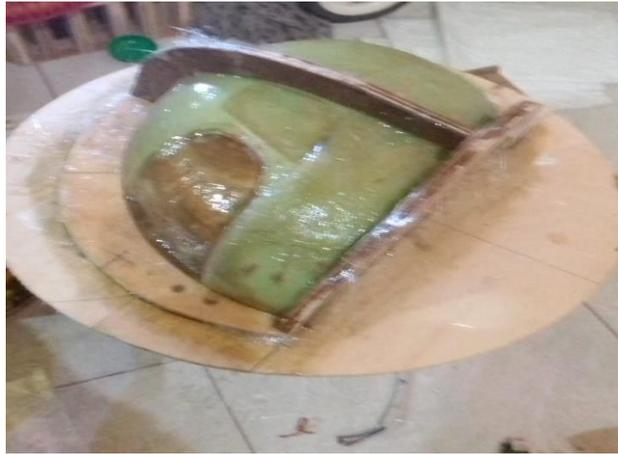
Gambar 4. 3 hasil pembuatan helm yang baru saja dibuka dari cetakan (mall) dan masih terlihat belum kering sempurna
