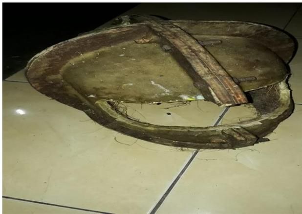
Gambar 4. 4 helm sebelum dibuka dari cetakan (mall)
