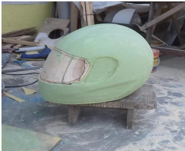
Gambar 4. 2 hasil pembuatan helm setelah dihalusi permukaannya setelah di dempul
