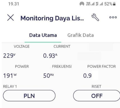
Gambar 4. 5 Monitoring beban dispenser sebelum menggunakan inverter filter
