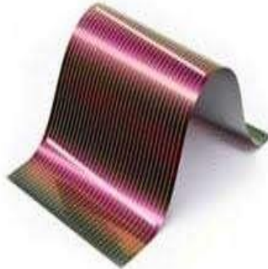
Gambar 2.12 Solar sel jenis Copper Indium Diselenide
