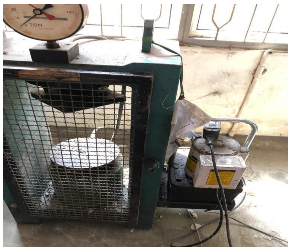
Gambar 3.11 Pengujian Kuat Tarik Beton
