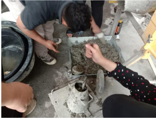
Lampiran 28: Proses perojokan adukan beton.
