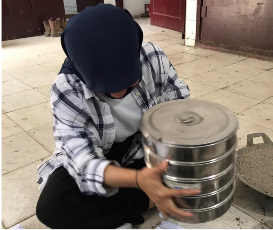
Gambar L.7: Proses Penyaringan Agregat
