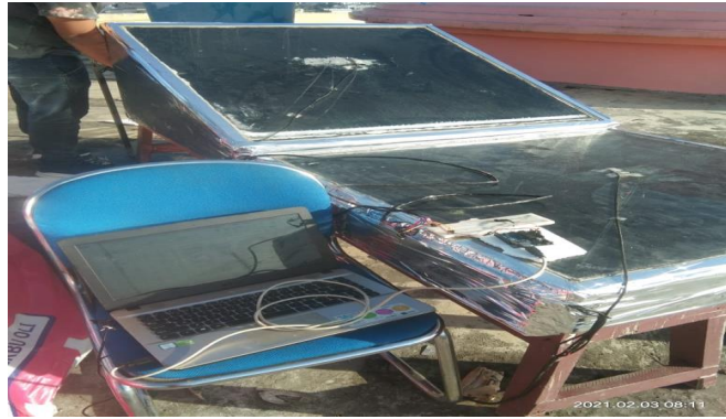
Gambar 4.13 Merekam dengan menggunakan termokopel
