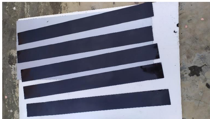
Gambar 4.2 Plat alumunium yang sudah dicat hitam
