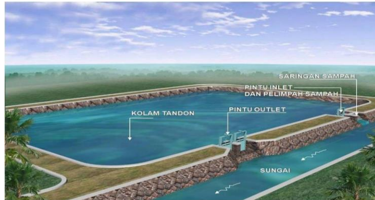
Gambar 2.1: Kolam retensi tipe disamping badan sungai. Sumber: (Kementrian PUPR, 2018).
