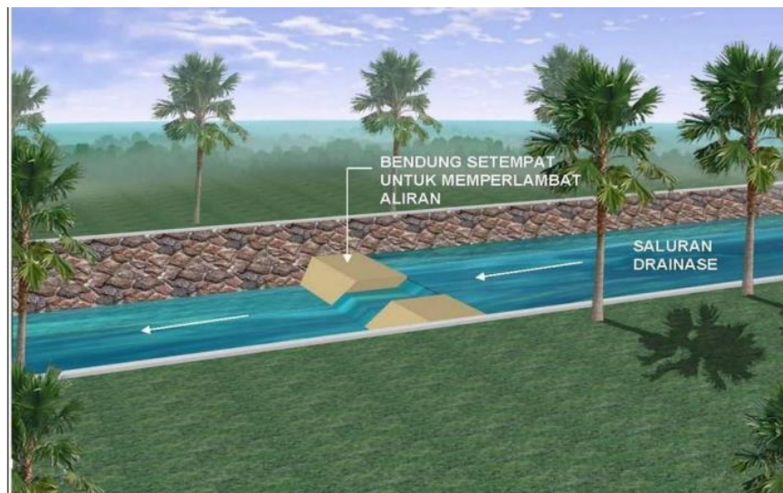
Gambar 2.3: Kolam Retensi Tipe Storage Memanjang. Sumber: (Kementrian PUPR, 2018).
