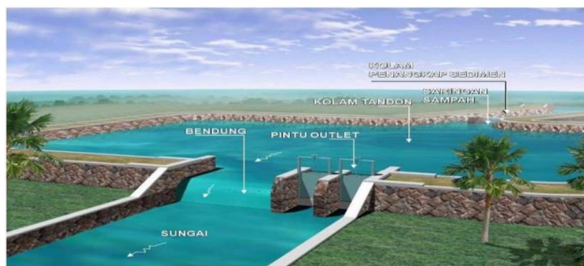
Gambar 2.2: Kolam retensi tipe didalam badan sungai. Sumber: (Kementrian PUPR, 2018).
