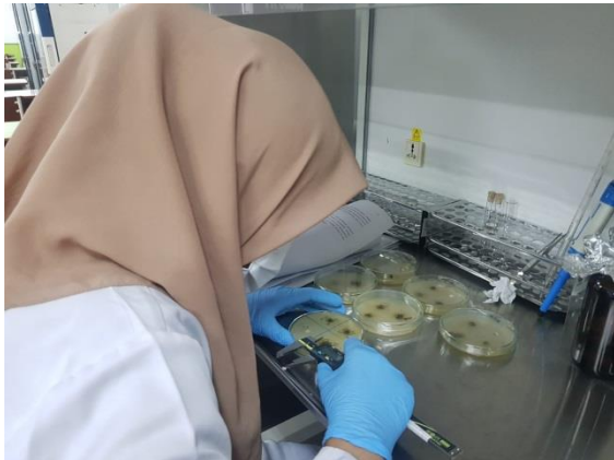
Tahap Pengamatan setelah 24 jam dengan mengukur Diameter Zona Hambat Pertumbuhan Bakteri Cutibacterium acnes menggunakan Jangka Sorong
