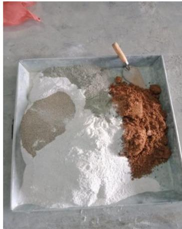
Gambar L-15 Bata Variasi Campuran Semen + Tanah Merah + Pasir + ASP
