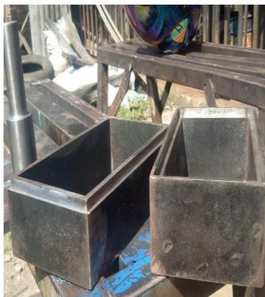
Gambar L-8 Alat Cetak Bata
