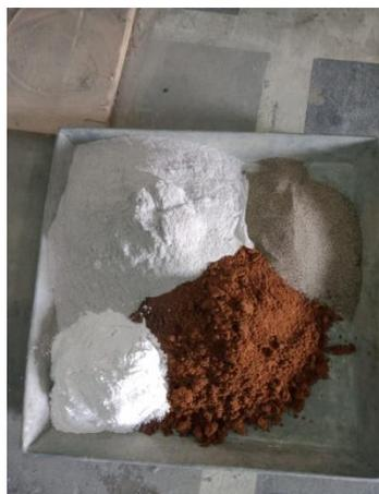
Gambar L-16 Bata Variasi Campuran Semen + Tanah Merah + Pasir + ASP
