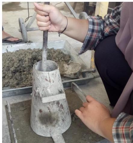
Gambar L- 3: Pengujian Slump Test
