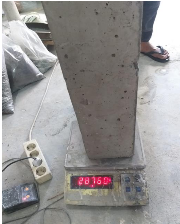
Gambar L.9 : Benda uji balok di timbang sebelum di uji
