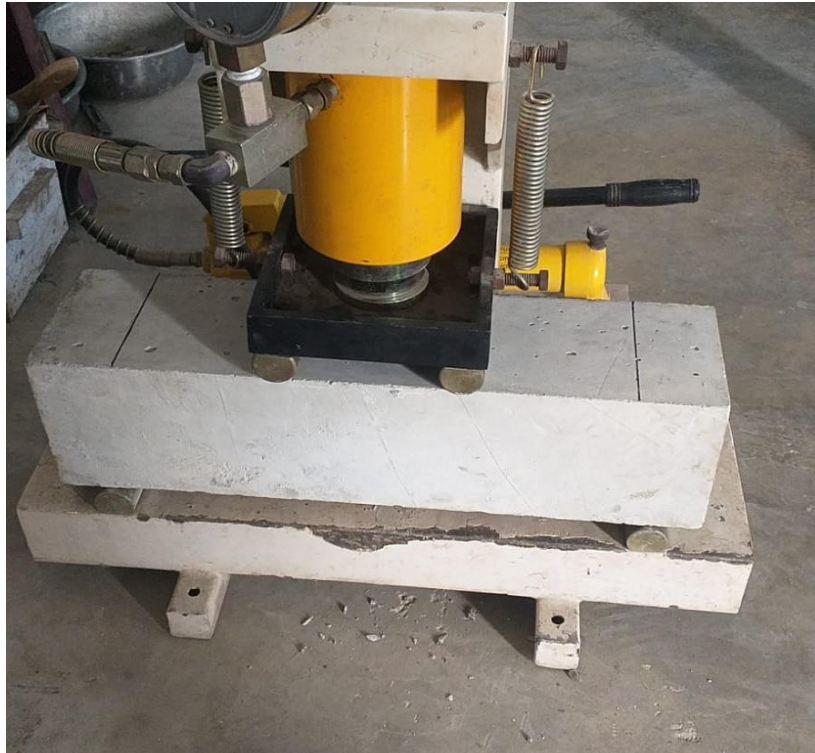
Gambar L.8: Pengujian Kuat lentur beton
