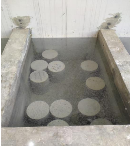
Gambar L.8 : Benda uji silinder pada saat perendaman
