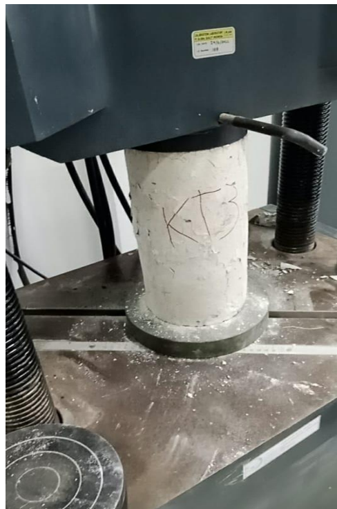
L.11 : Pengujian kuat tekan beton
