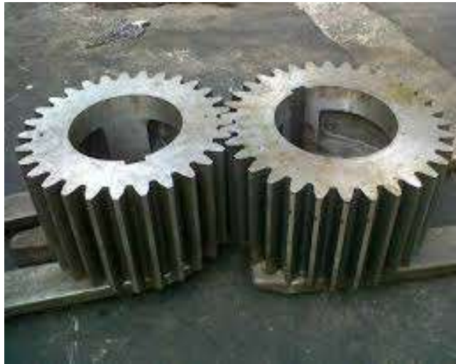
Gambar. 2.1 Roda gigi lurus (sularso 1997)
