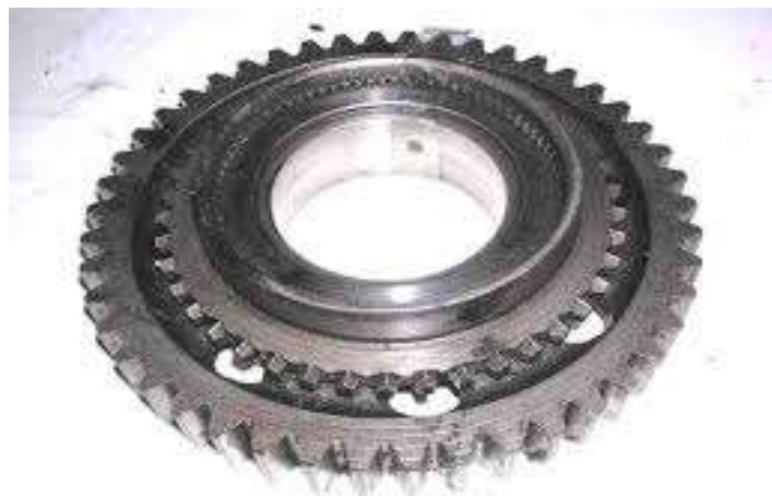
Gambar. 2.4 Roda gigi dalam (sularso 1997)
