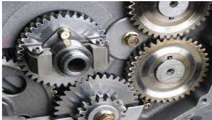
Gambar 2.14 roda gigi sebagai pengubah putaran ( https://ilmuteknikmesinindonesia.blogspot.com )
