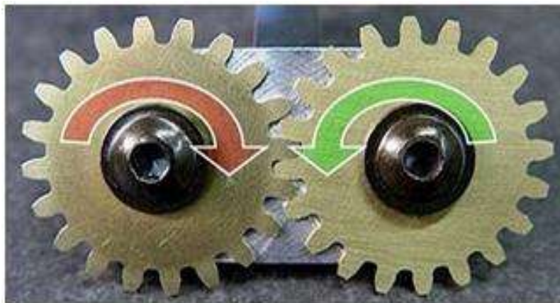
Gambar 2.20 Cara kerja roda gigi
