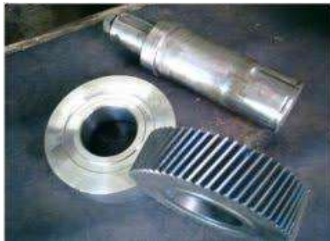
Gambar. 2.2 Roda gigi miring (sularso 1997)
