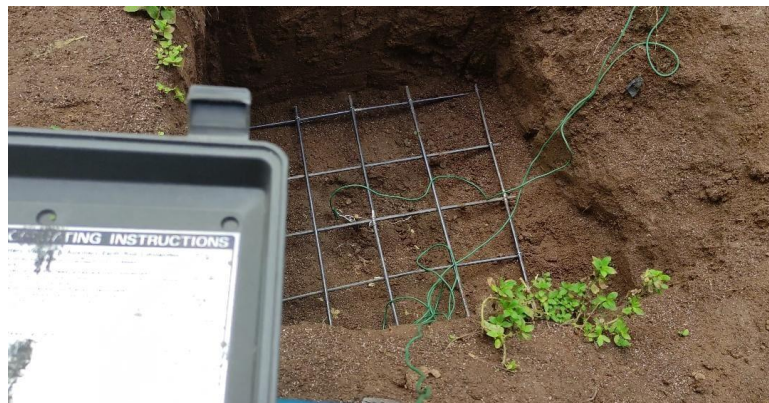
Gambar 2. Pengukuran Elektroda Rod Dengan Penambahan Mesh
