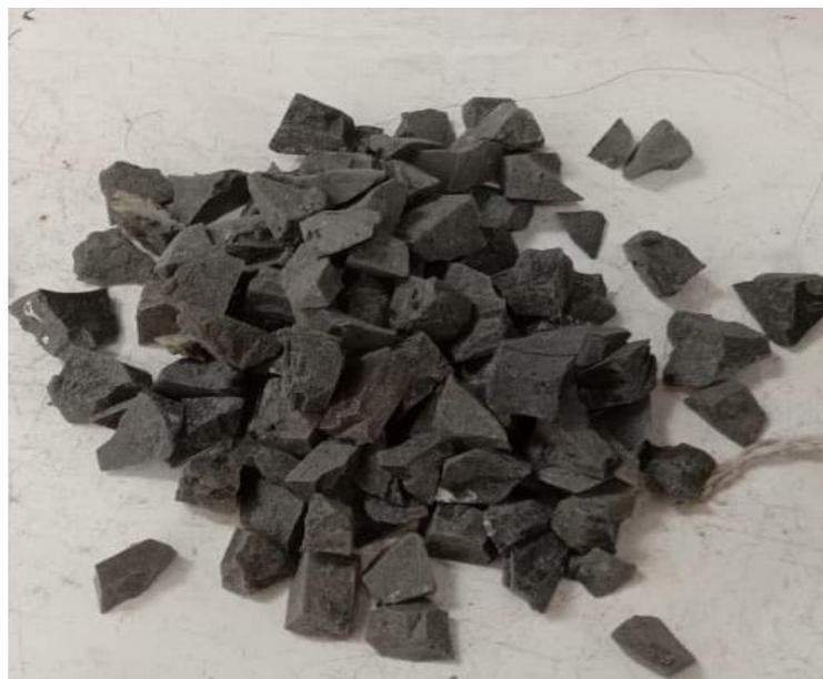
Gambar 3.9: Agregat kasar dari plastik HDPE
