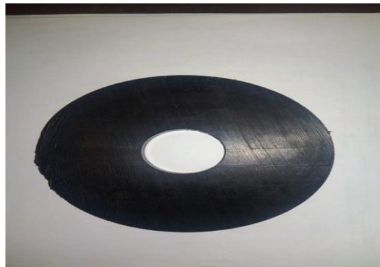
Gambar 3.10: Bahan komposit sebelum di bubut.
