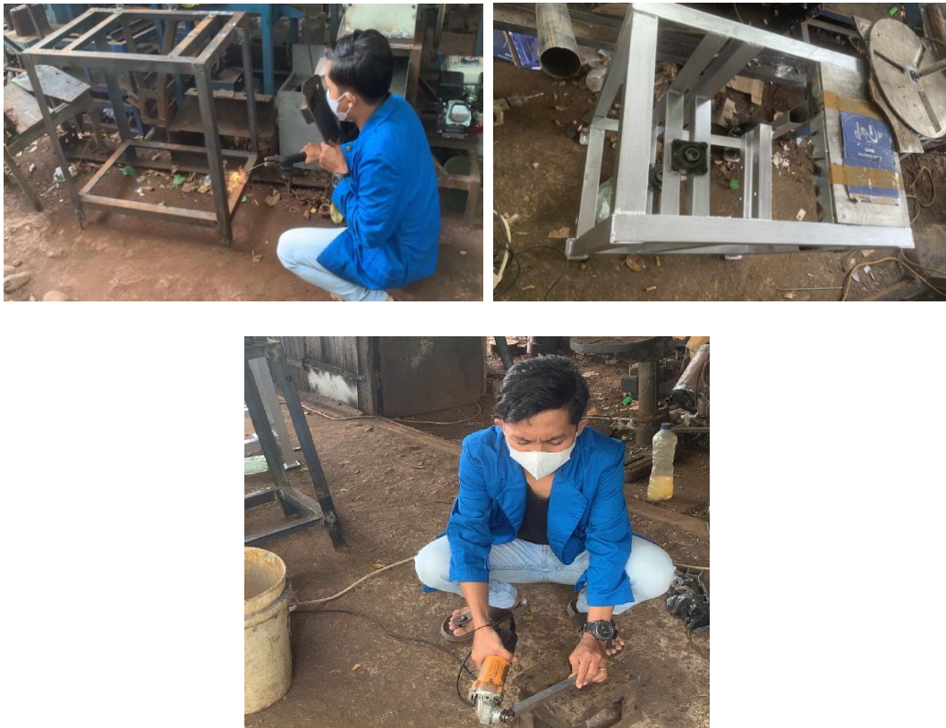
Gambar 4.1. Pembuatan Rangka Alat Perajang Singkong
