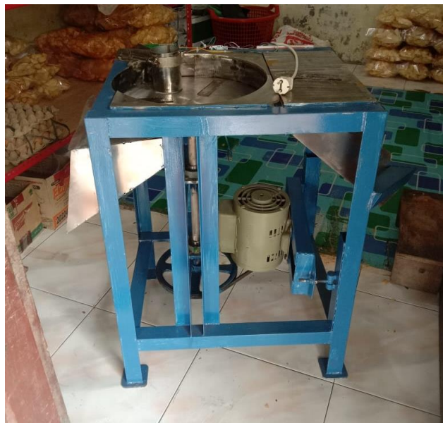
Gambar 4.4. Rangka Alat Perajang Singkong Otomatis
