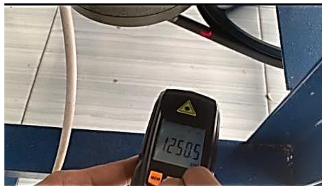
Gambar 4.3. Pengujian RPM menggunakan Tacho Meter
