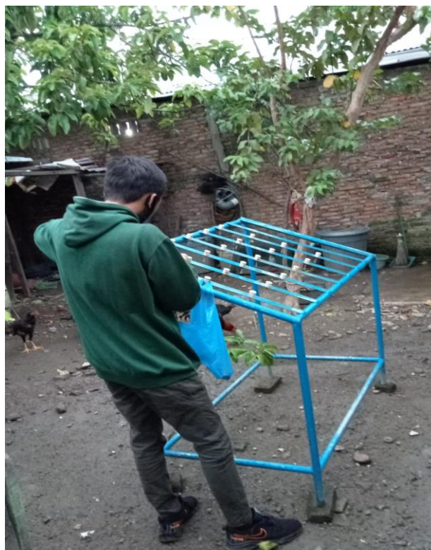
Gambar proses peletakan specimen uji di titik lokasi penelitian
