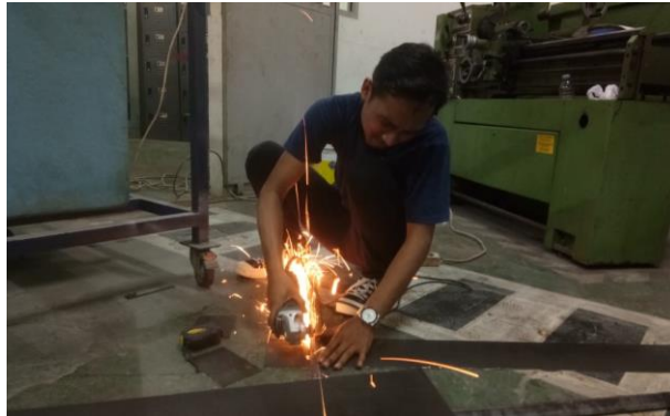
Gambar proses pemotongan Specimen Uji
