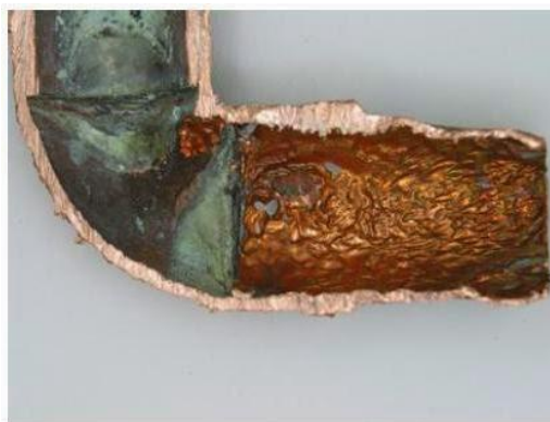
Gambar 2.4. korosi erosi (Treathewey, 1991)
