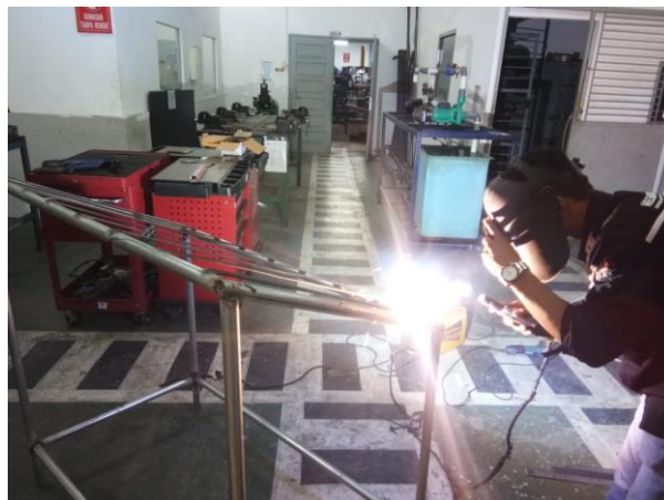
Gambar proses pengelasan rak pengujian
