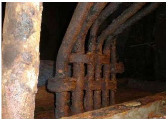
Gambar 2.2 Korosi Seragam Pada Pipa Ballast (Treathevey, 1991)
