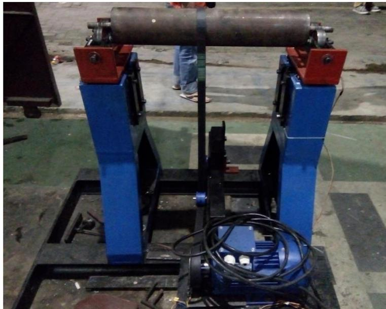
Gambar 3.18. Pemasangan Spesimen pada Mesin Balancing
