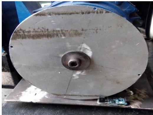
Gambar 3.8. Sensor Kecepatan
