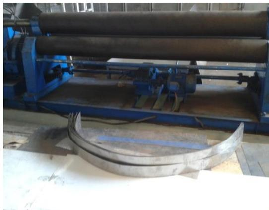
Gambar 2.11. Pully roll plat pada mesin bending
