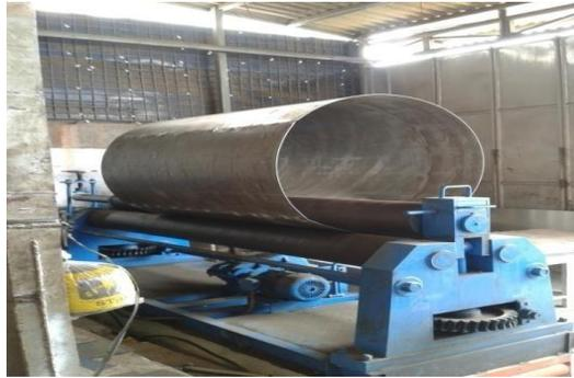
Gambar 2.10. Proses kerja pully roll plat pada mesin bending
