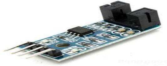
Gambar 2.14. Sensor Kecepatan
