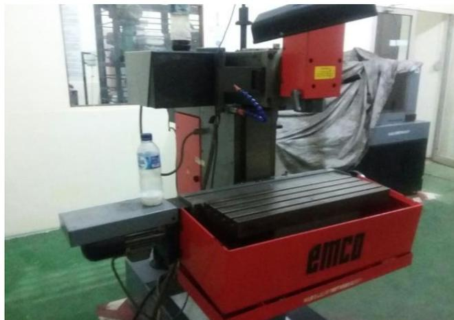
Gambar 3.10. Mesin Frais ( *Milling* )
