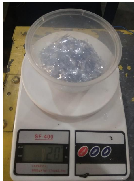
Gambar 4.7. Spesimen berat bahan plastik PET 20 gram.
