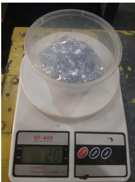
Gambar 4.22. Spesimen berat bahan plastik PET 20 gram.
