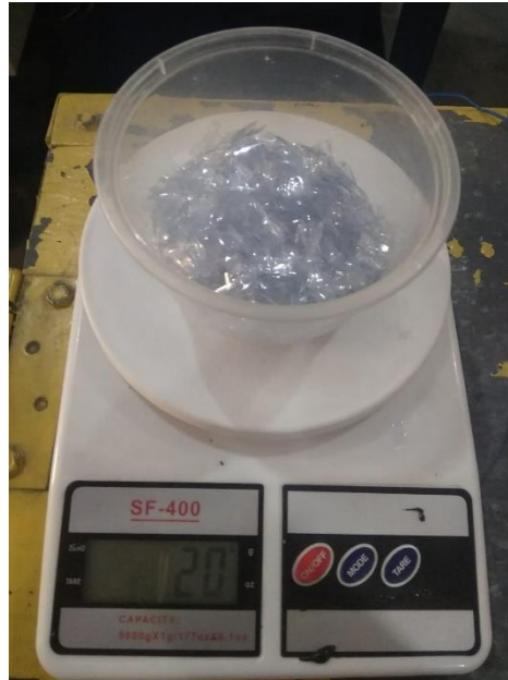
Gambar 4.12. Spesimen berat bahan plastik PET 20 gram.
