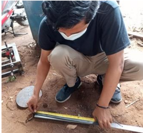
Gambar 4.2 Mengukur Besi Siku
