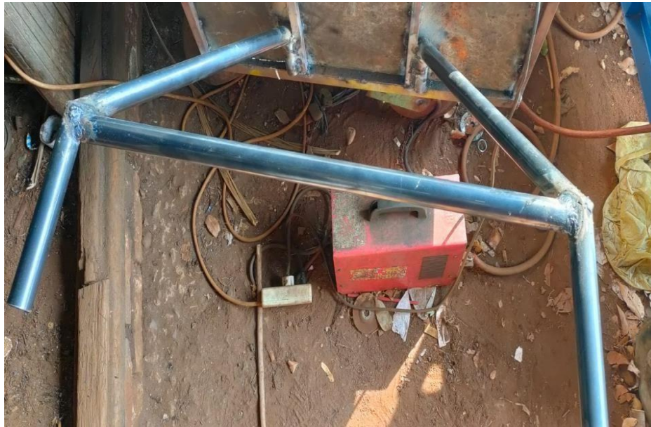
Gambar 4.8 pembuatan stang pengemudi
