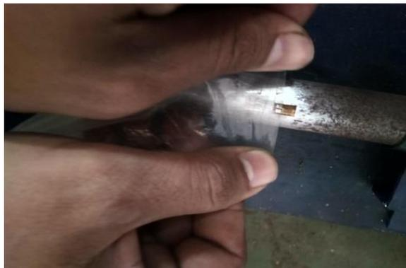
Gambar 3.10 Pemasangan Strain Gages
