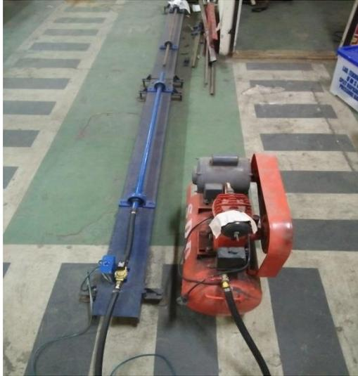
Gambar 3.9 Alat uji impak batang hopkinson Horizontal
