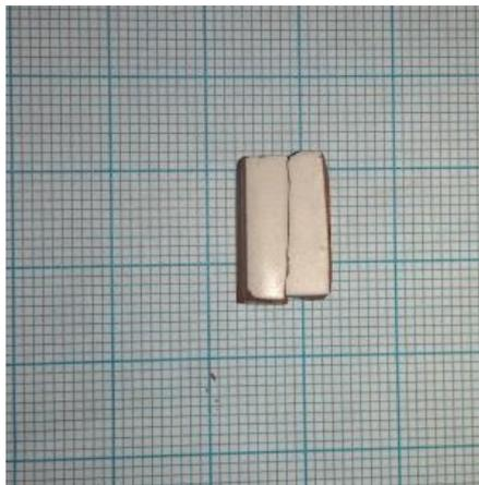
Gambar 4.2 sesudah uji tekan statis pada spesimen keramik
