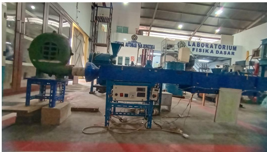
Gambar 3.21 Saluran Udara Segiempat
