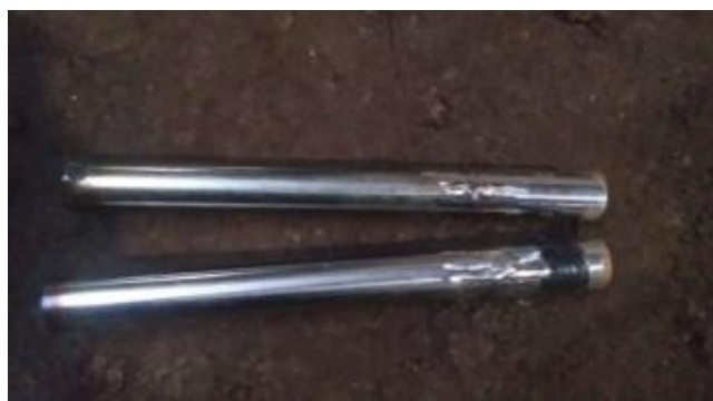
Gambar 4.28. Hasil Pemotongan Dengan Panjang 110 mm
