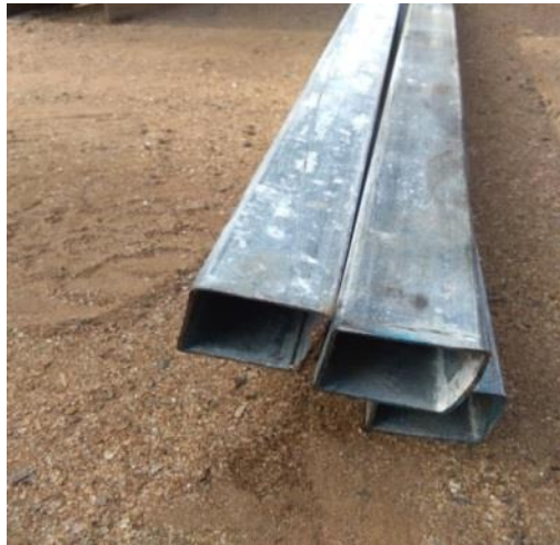
Gambar 4.37. Hollow Stainless Steel Dengan Ukuran 30mm x 30mm
