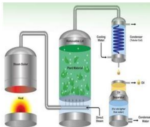
Gambar 2.7. Penyulingan Dengan Uap Langsung (Dika, D. R. 2019)
