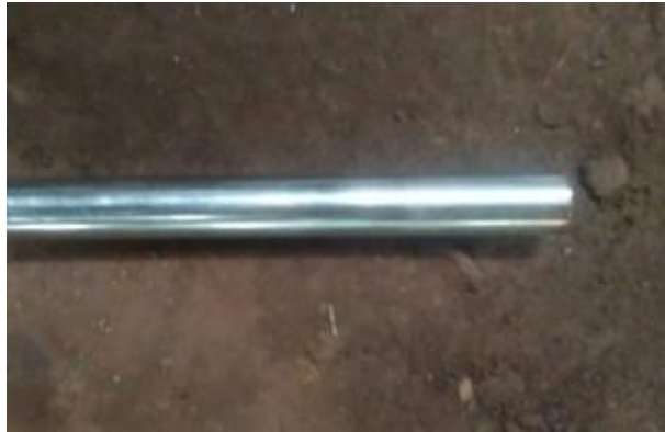
Gambar 4.26. Hasil Pemotongan Dengan Panjang 165 mm
