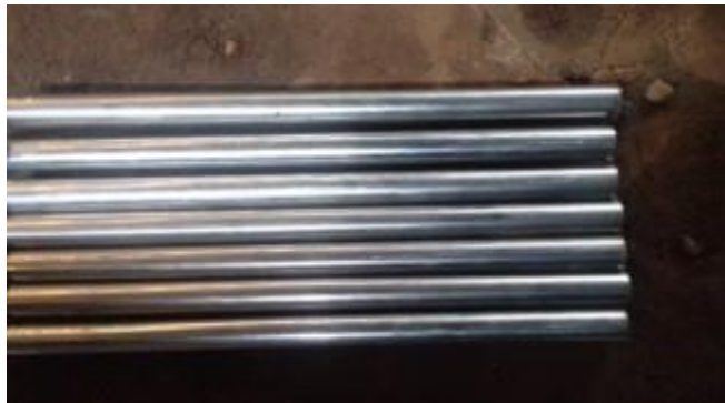
Gambar 4.24. Hasil Pemotongan Dengan Panjang 330 mm
