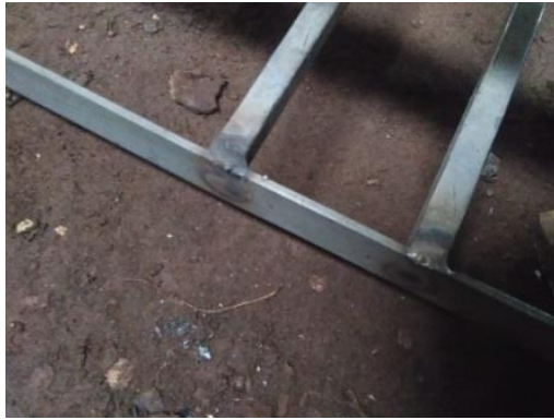
Gambar 4.57. Hasil Pengelasan Hollow Pada Plat Strip
