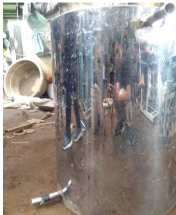
Gambar 4.19. Hasil Dari Pengelasan Pipa Stainless Pada Tabung
