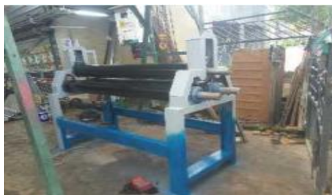
Gambar 2.18. Mesin rolling (Wibowo, R. K. K., & Soekarno, S. 2022)
