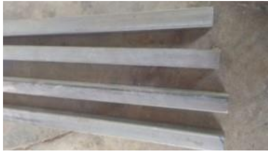
Gambar 4.39. Hasil Pemotongan Hollow Stainless Steel Dengan Panjang 500mm
