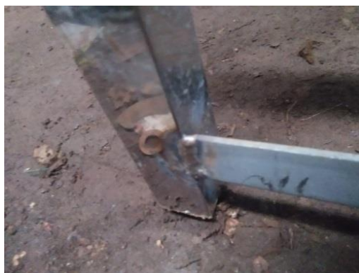
Gambar 4.50. Hasil Pengelasan Plat Pada Kakian Dudukan
