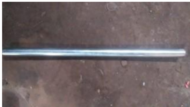
Gambar 4.25. Hasil Pemotongan Dengan Panjang 365 mm
