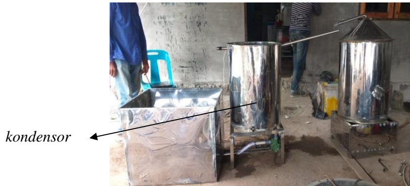
Gambar 3.22. Rangkaian Alat Penyulingan Daun Nilam Menjadi Minyak Atsiri Kapasitas 5 Kg
