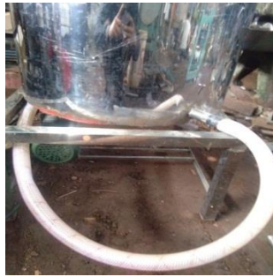
Gambar 4.66. Pemasangan Pipa Pada Tabung Kondensor
