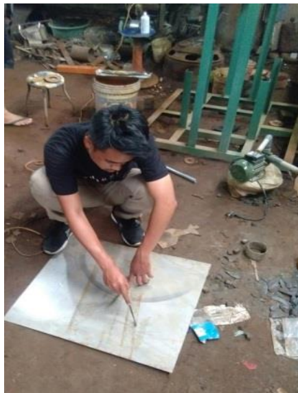
Gambar 4.9. Mengukur Plat Stainless Steel Menggunakan Jangka
