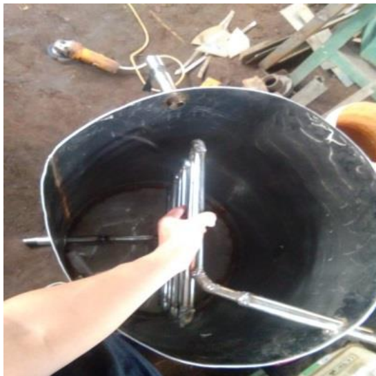
Gambar 4.34. Hasil Dari Pengelasan Pipa Multibular Pada Tabung
