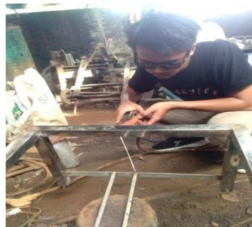
Gambar 4.56. Proses Pengelasan Hollow Pada Plat Strip
