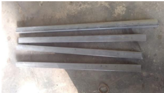
Gambar 4.40. Hasil Pemotongan Hollow Stainless Steel Dengan Panjang 280mm
