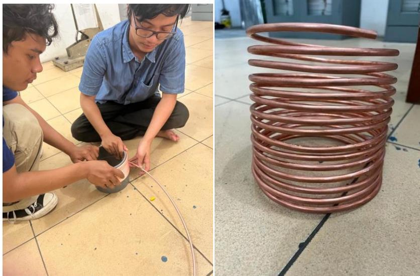
Gambar 3.29 Perakitan *Helical Coil*
