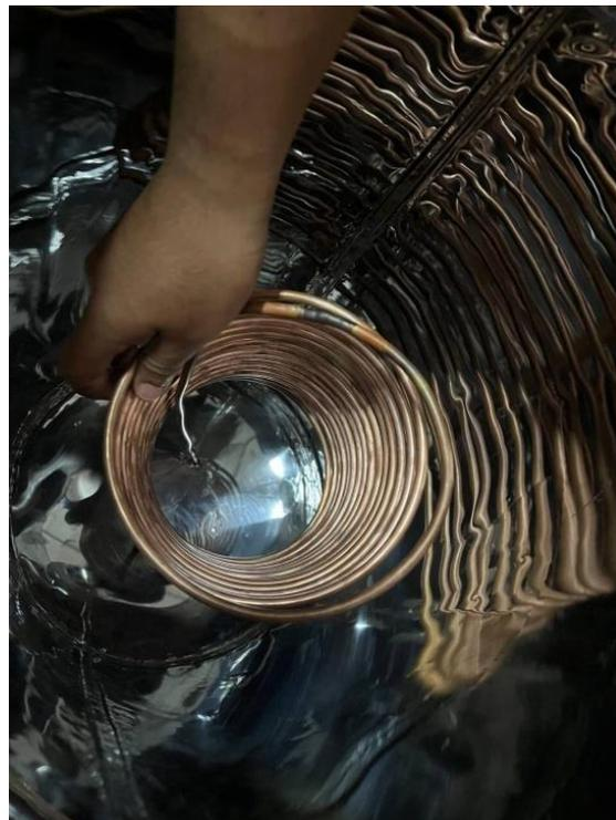
Gambar 3.30 Memasang APK ke Dalam Tangki Air
