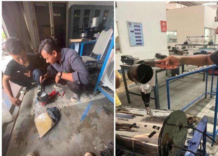
Gambar 3.38 Proses Pengisian *Parafin Wax* ke Tangki
