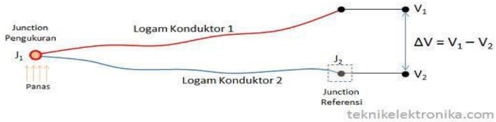
Gambar 2.2 Kontruksi Prinsip Kerja Thermocouple (Alwie et al., 2010)
