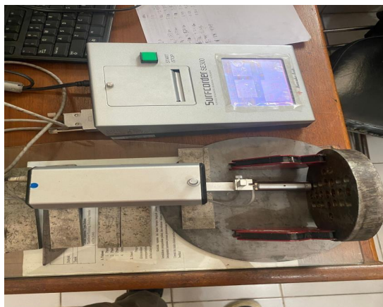
Gambar 4.5 Proses pengukuran kekasaran
