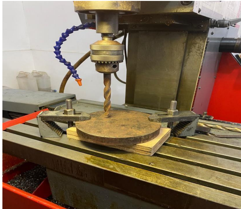
Gambar 4.13 pengeboran tanpa coolant
