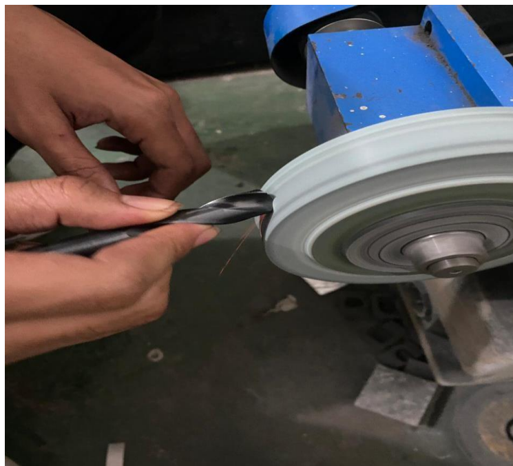
Mengasah sudut twist drill
