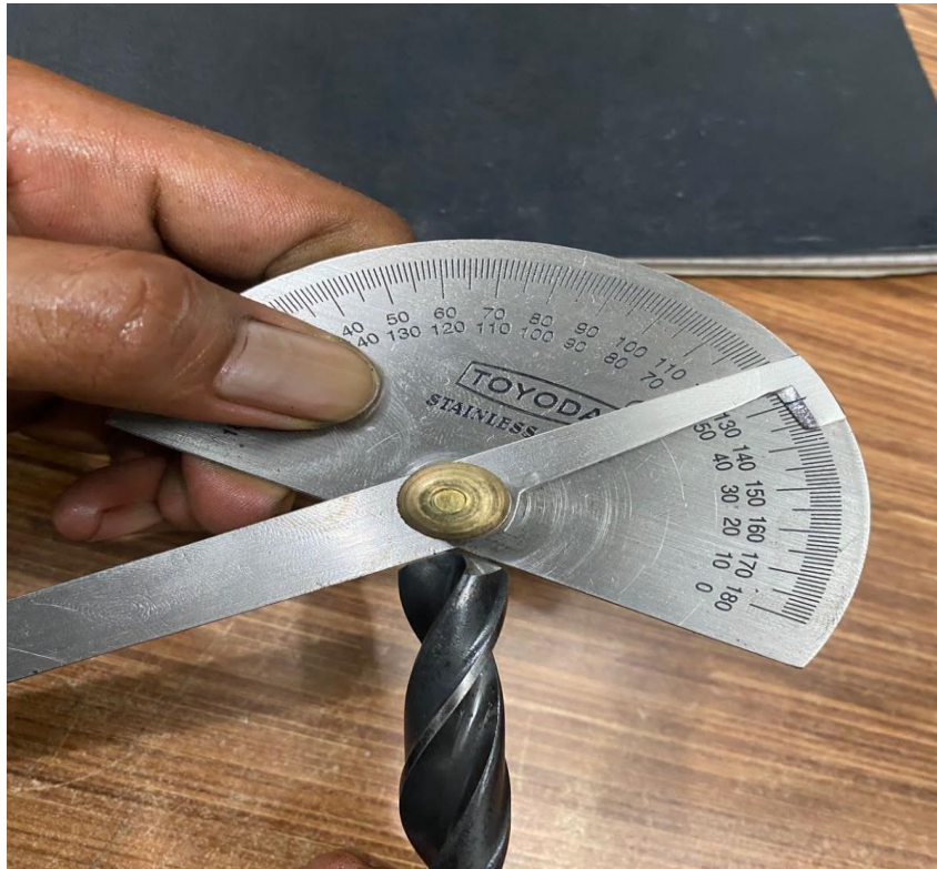
Mengukur sudut twist drill
