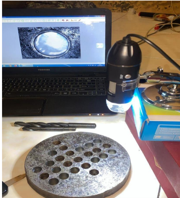
Gambar 4.6 Proses uji kebulatan
