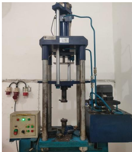
Gambar 3.8 Mesin uji tekan (FT.Umsu)
