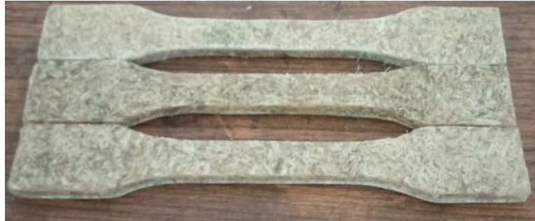
Gambar 4.2 Spesimen uji tarik 70%:30%
