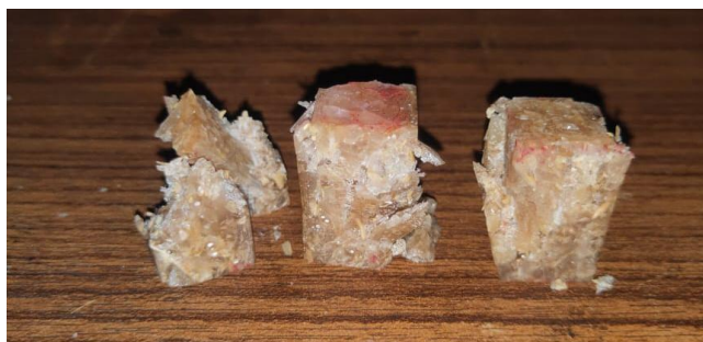
Gambar 4.16 Hasil pengujian tekan resin dan 30%
