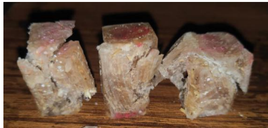
Gambar 4.17 Hasil pengujian tekan 90% resin 10%
