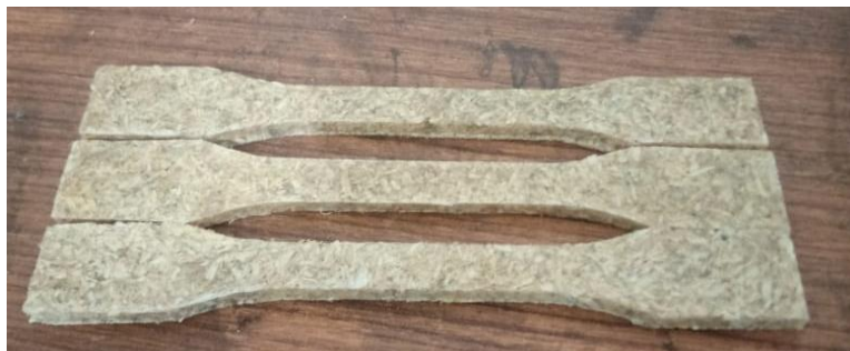
Gambar 4.3 Spesimen uji tarik 80%:20%
