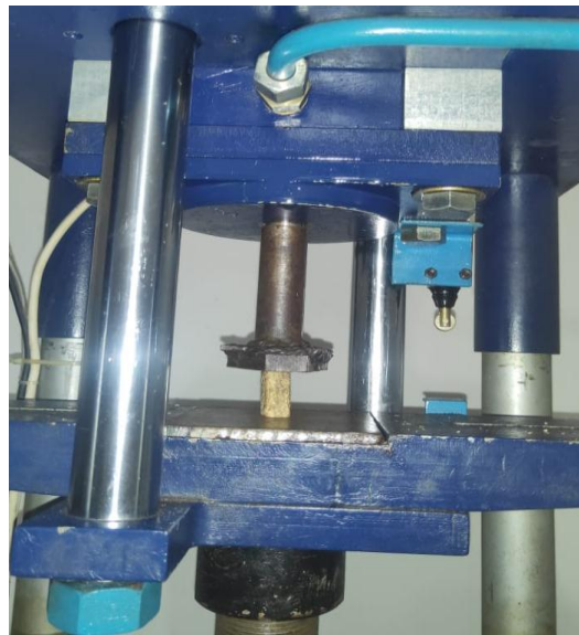
Gambar 3.26 Pemasangan spesimen uji tekan
