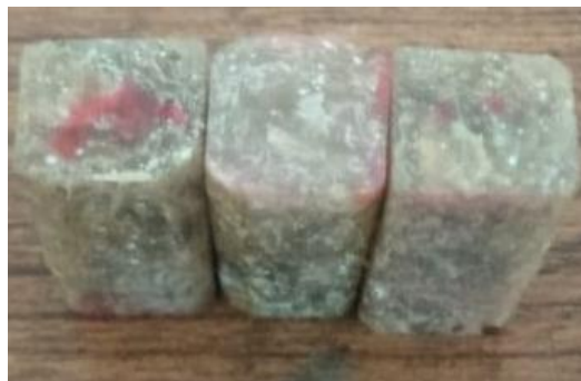
Gambar 4.13 Spesimen uji tekan 70%:30%
