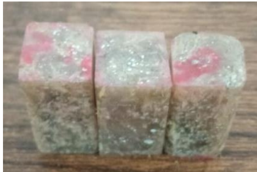
Gambar 4.14 Spesimen uji tekan 80%:20%
