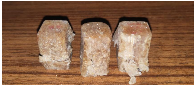
Gambar 4.17 Hasil pengujian tekan 80% dan 20%
