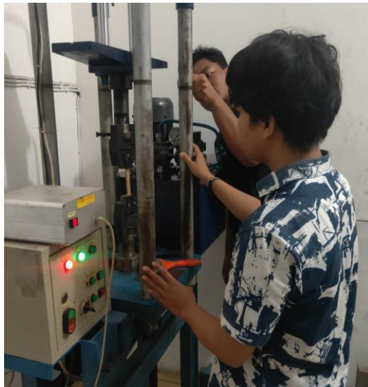
Gambar 3.25 pemasangan spesimen uji tarik
