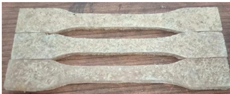
Gambar 4.4 Spesimen uji tarik 90%:10%
