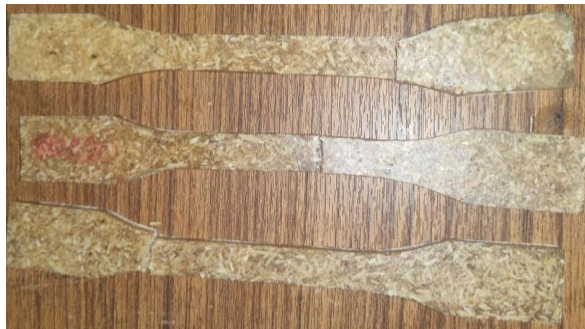
Gambar 4.6 Hasil pengujian tarik 80% : 20%
