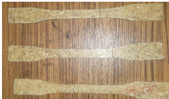
Gambar 4.6 Hasil pengujian tarik 80% : 20%
