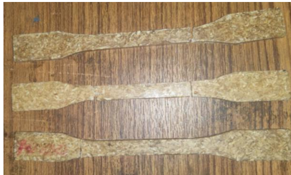
Gambar 4.5 Hasil pengujian tarik 70% : 30%
