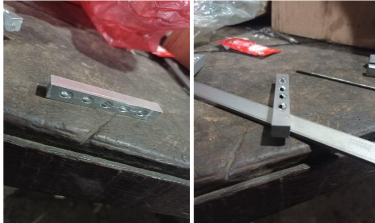
Gambar 4.10 Proses Pembuatan Lubang Alumunium
