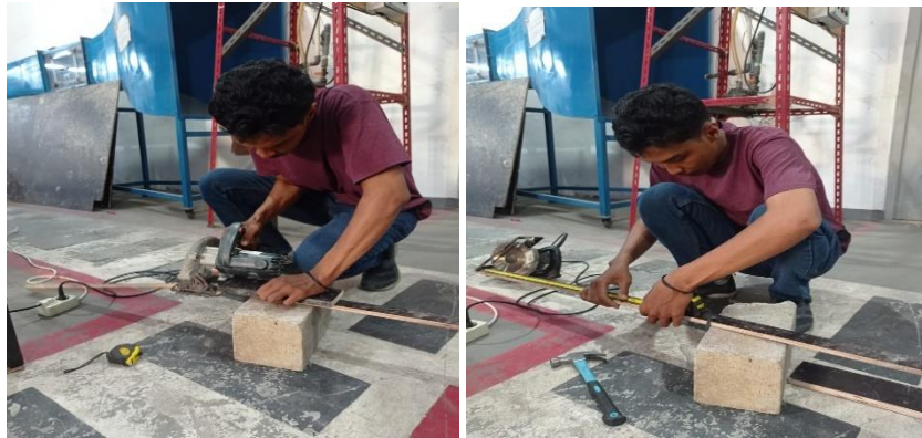
Gambar 4.13 Proses Pemotongan Triplek
