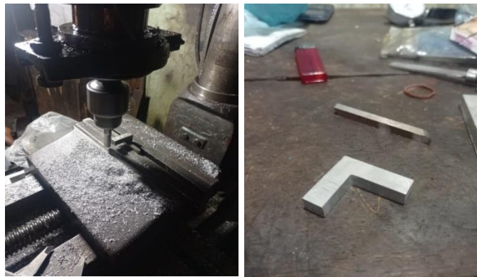
Gambar 4.5 Pemotongan dan Pengikisan Rusuk V
