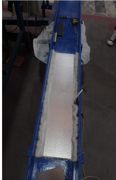
Gambar 4.27 Posisi Tutup heater Menggunakan Mika Tahan Panas
