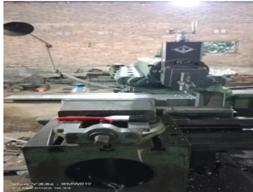
Gambar 4.8 Pemotongan Dengan Mesin Sekrap
