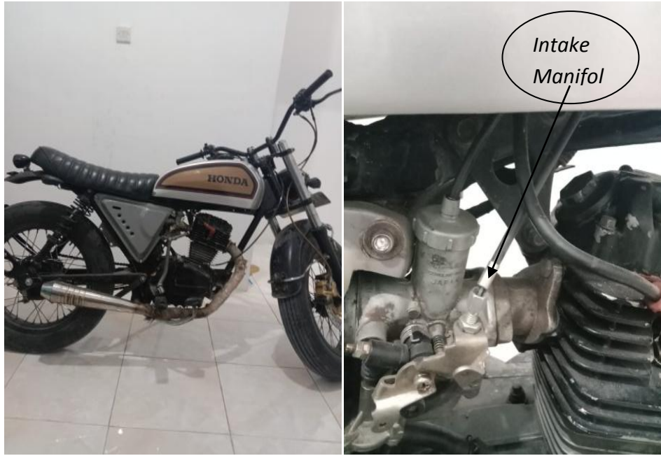
Gambar 3.12 a. Sepeda Motor Honda GL Pro 150 b. Posisi Intake Mnaifold
