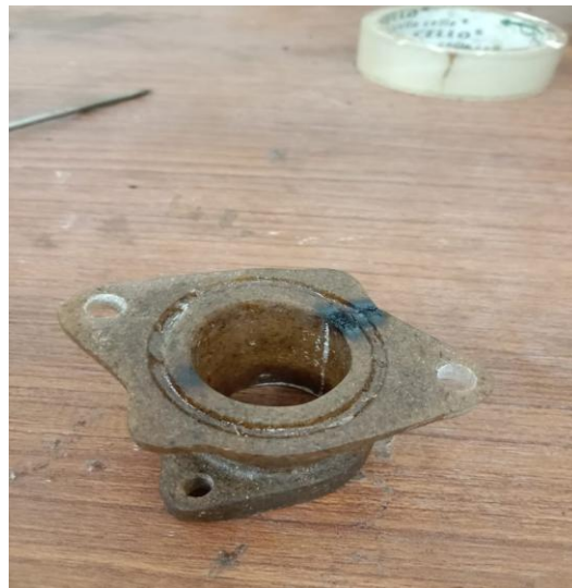
Gambar 4.21 Spesimen 3 Setelah di Uji Termal
