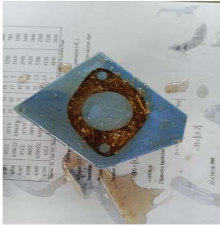
Gambar 3.24 a. Cetakan silikon dan b. Intake Manifold
