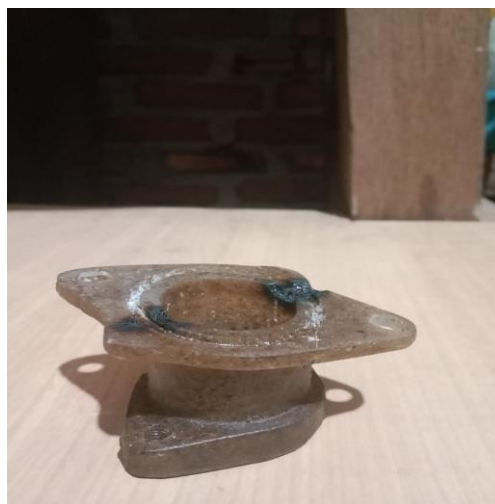
Gambar 4.27 Spesimen 5 Setelah di Uji Termal
