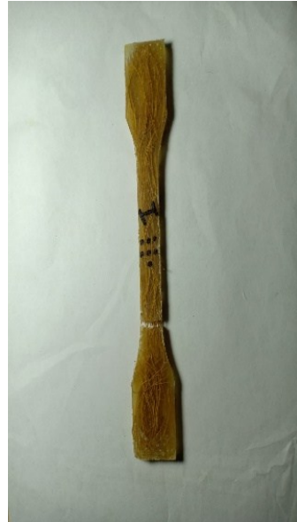
Gambar 4.6 Sebelum Dan Sesudah Pengujian Perlakuan Kimia Selama 7 jam komposisi 10% serat
