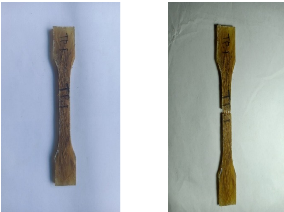
Gambar 4.1 Sebelum Dan Sesudah Pengujian Tarik Tanpa Perlakuan Kimia 10%
