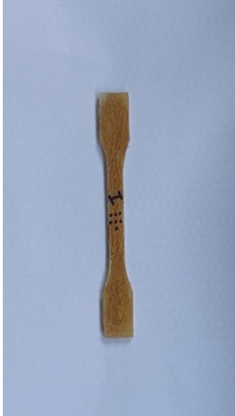
Gambar 4.6 Sebelum Dan Sesudah Pengujian Perlakuan Kimia Selama 7 jam komposisi 10% serat
