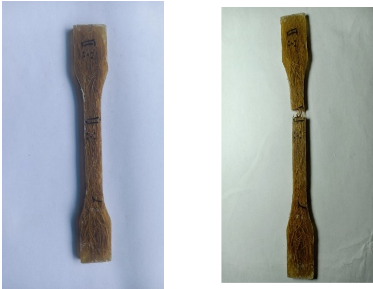
Gambar 4.10 Sebelum Dan Sesudah Pengujian Perlakuan Kimia Selama 5 jam komposisi 20% serat
