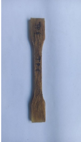
Gambar 4.2 Sebelum Dan Sesudah Pengujian Tarik Tanpa Perlakuan Kimia 20%
