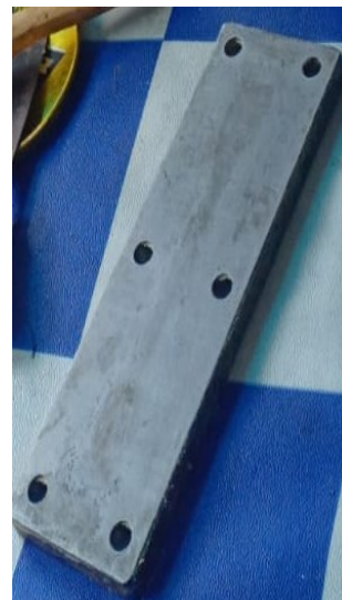
Gambar 3.19 Cetakan uji Tarik yang telah di lapisan Moldrelase Wax
