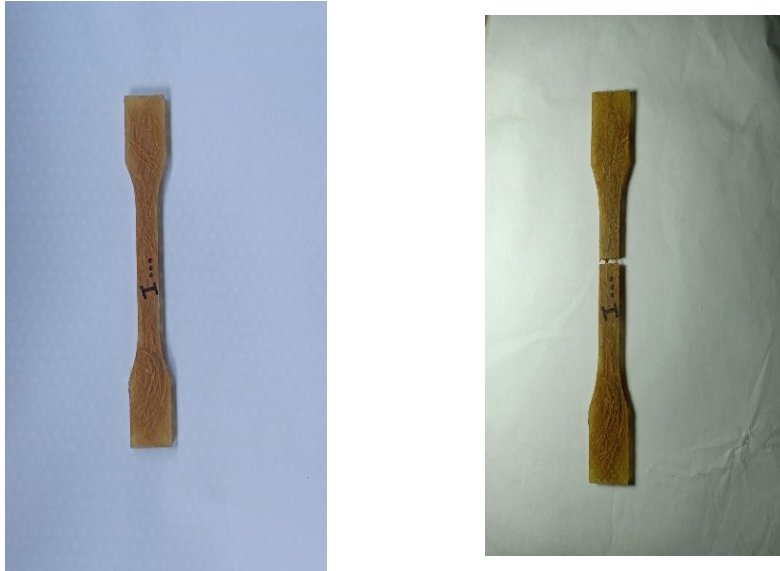
Gambar 4.4 Sebelum Dan Sesudah Pengujian Perlakuan Kimia Selama 3 jam komposisi 10% serat
