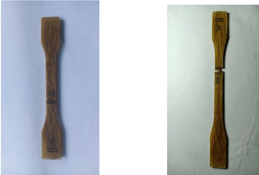
Gambar 4.12 Sebelum Dan Sesudah Pengujian Perlakuan Kimia Selama 9 jam komposisi 20% serat
