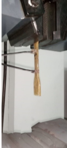
Gambar 3.24 Memasang specimen Tarik pada cekam mesin Universal Testing Machine
