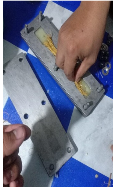
Gambar 3.20 Proses penuangan resin dan peyusunan serat pinang ke dalam cetakan
