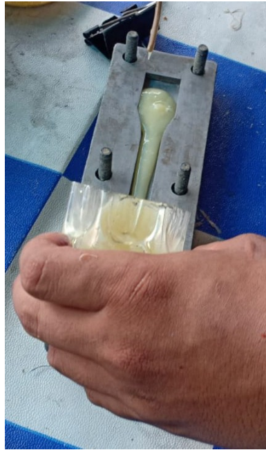
Gambar 3.20 Proses penuangan resin dan peyusunan serat pinang ke dalam cetakan
