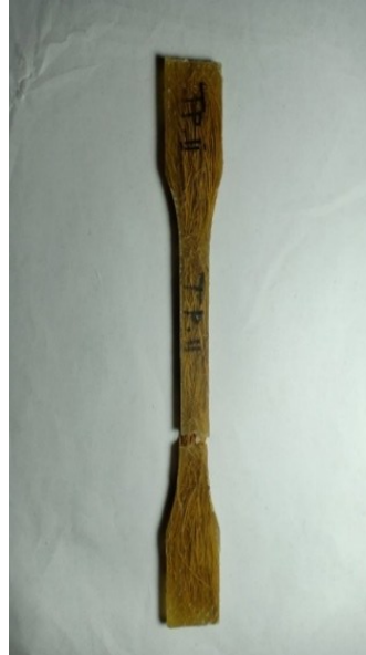
Gambar 4.2 Sebelum Dan Sesudah Pengujian Tarik Tanpa Perlakuan Kimia 20%
