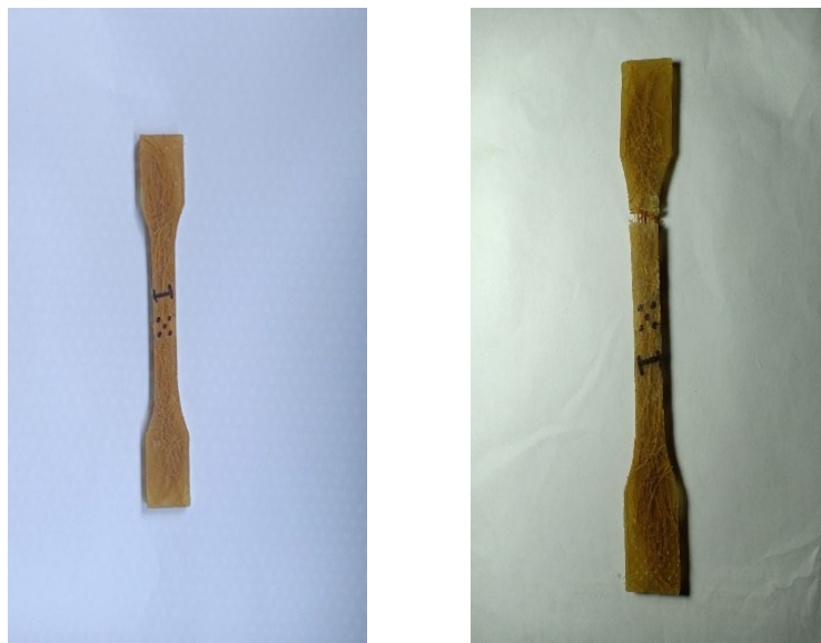
Gambar 4.5 Sebelum Dan Sesudah Pengujian Perlakuan Kimia Selama 5 jam komposisi 10% serat
