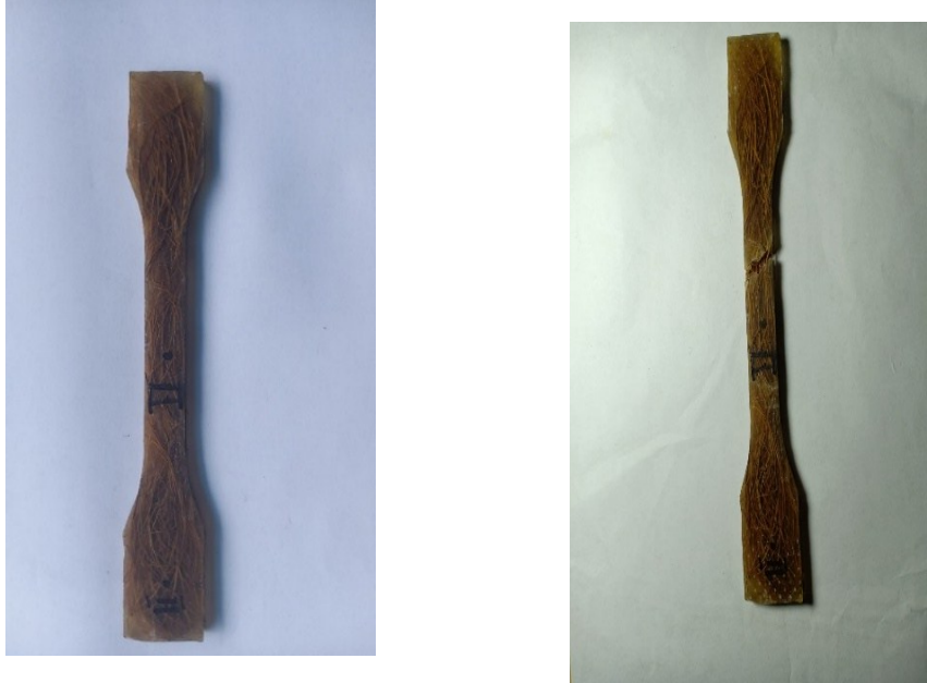
Gambar 4.8 Sebelum Dan Sesudah Pengujian Perlakuan Kimia Selama 1 jam komposisi 20% serat
