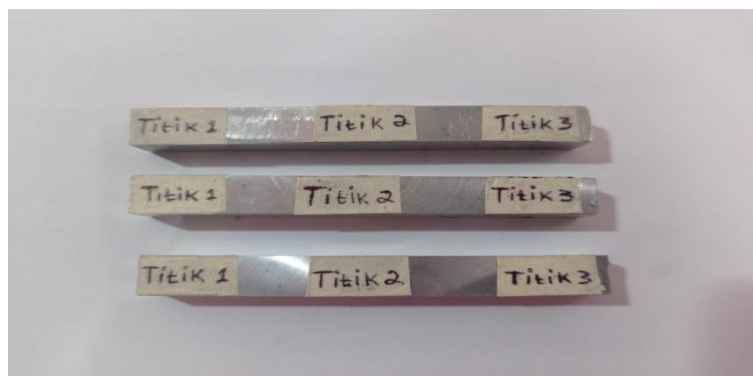
Gambar 4.8 Spesimen pada penggunaan cairan pendingin minyak tanah.
