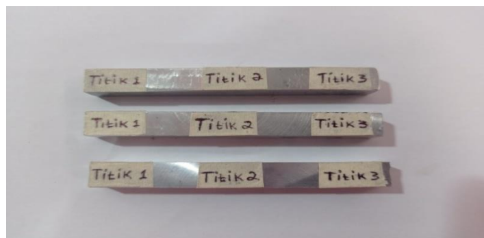
Gambar 4.7 Spesimen pada penggunaan cairan pendingin dexlite
