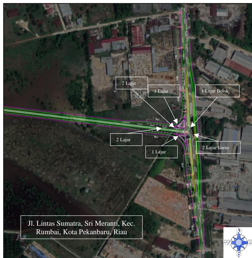
Gambar 3. 3 Simpang Sebidang Antara Jalan Masuk Tol Ruas Rengat – Pekanbaru Dengan Jalan Lintas Siak – Pekanbaru
