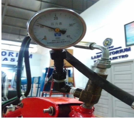
Gambar 3.10 peressur gueg tekanan silinder pada bucket 110 bar
