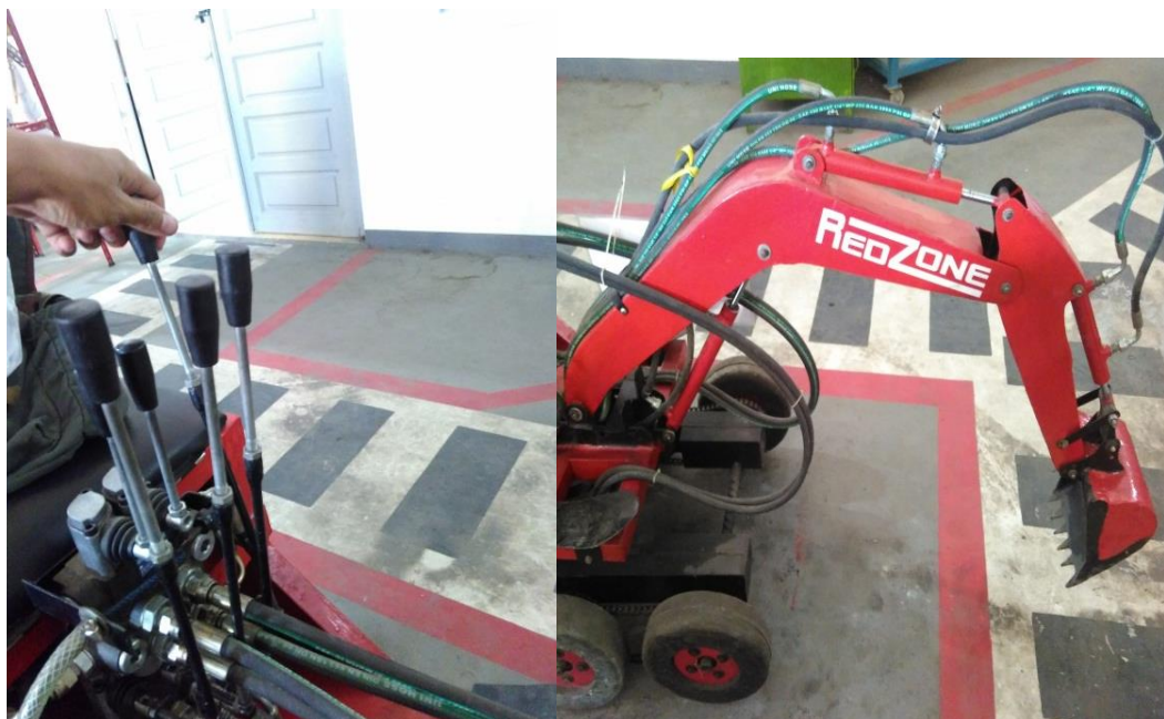
Gambar 4.7 tuas kendali saat di tarik dan hidrolik pada arm naik
