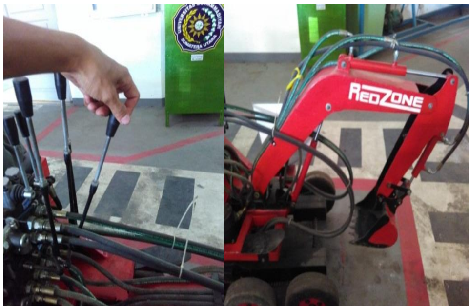
Gambar 4.4 tuas kendali saat di dorong dan hidrolik pada boom naik
