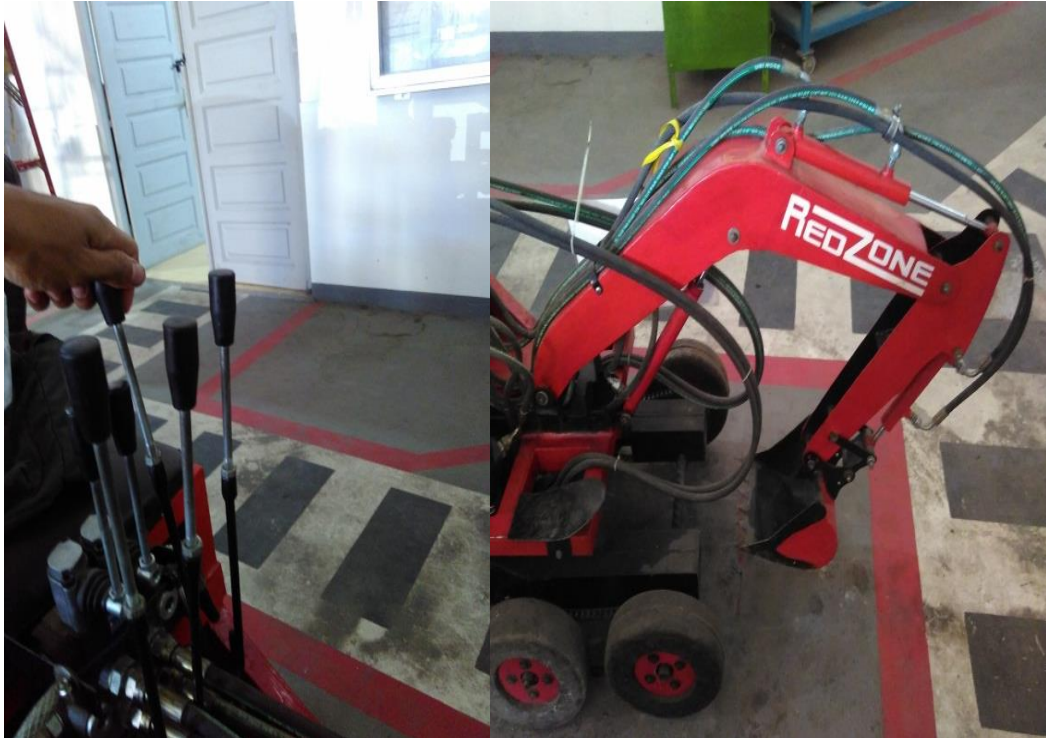
Gambar 4.10 tuas kendali saat di tarik dan hidrolik pada bucket turun
