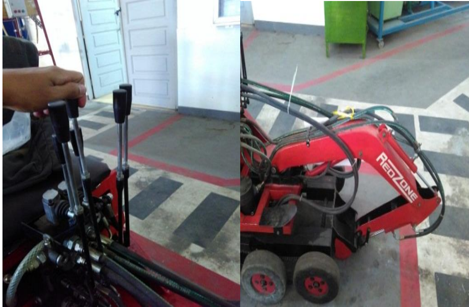
Gambar 4.3 tuas kendali saat di tarik dan hidrolik pada boom turun
