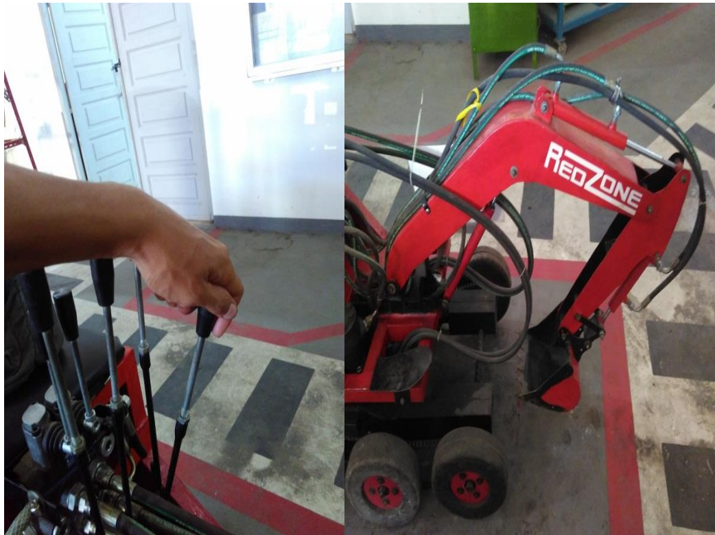
Gambar 4.6 tuas kendali saat di dorong dan hidrolik pada arm turun
