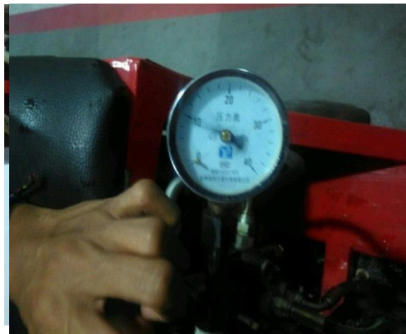
Gambar 3.7 peressur gueg tekanan pompa 140 bar
