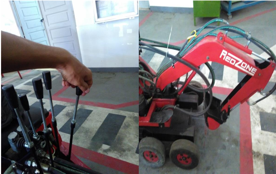
Gambar 4.9 tuas kendali saat di dorong dan hidrolik pada bucket naik
