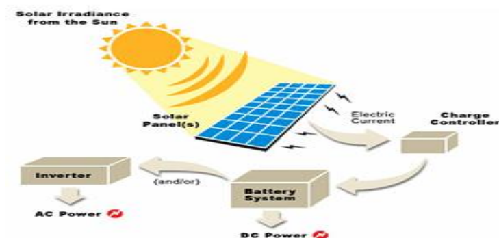
Gambar 2.1 Sistem Instalasi Menggunakan Solar cell (Sumber https://adyasolar.com/shop/plts/ )
