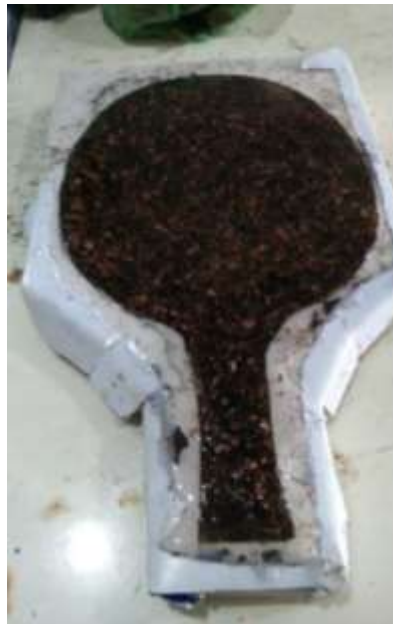
Gambar 4.18 Setelah dicampurkan bahan pada cetakan
