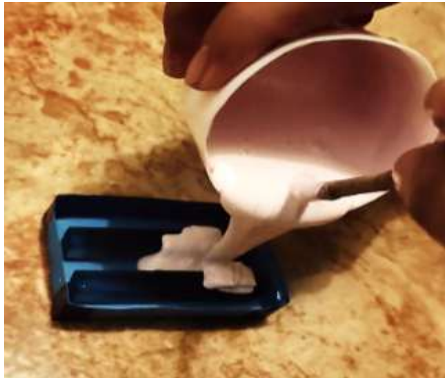
Gambar 4.1 Proses Pembuatan Cetakan Spesimen
