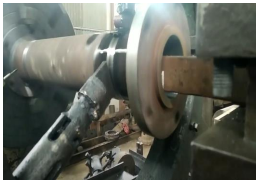
Gambar 3.29 proses pembuatan barrel Extruder Plastic
