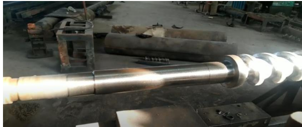
Gambar 3.31 Proses pembubutan screw
