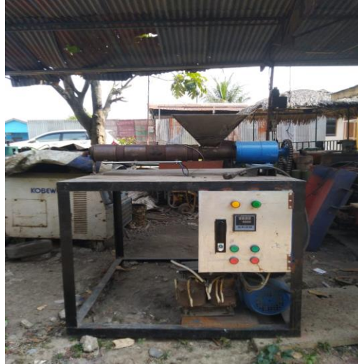
Gambar 4.1 Hasil perancangan mesin Extruder Plastic
