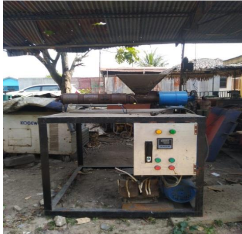
Gambar 3.28 Hasil pembuatan rangka Extruder Plastic
