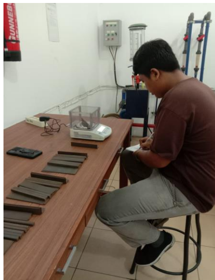
Foto penimbangan berat spesimen setelah di ekspos
