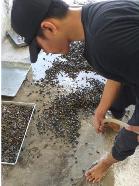
Pemeriksaan kadar lumpur agregat kasar
