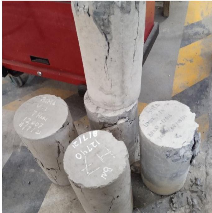
Gambar beton yang sudah diuji
