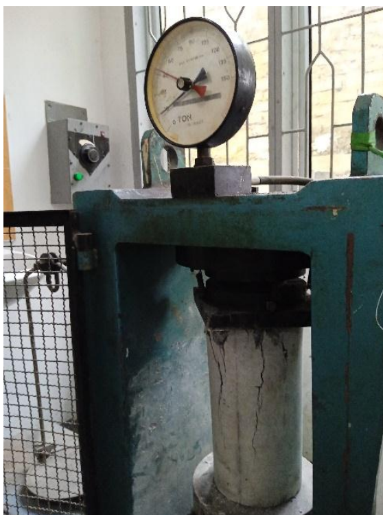
Proses pengujian kuat tekan beton
