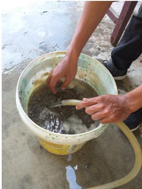
Pemeriksaan kadar lumpur agregat halus
