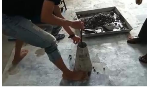
Lampiran 28 : Proses Perojokan Adukan Beton
