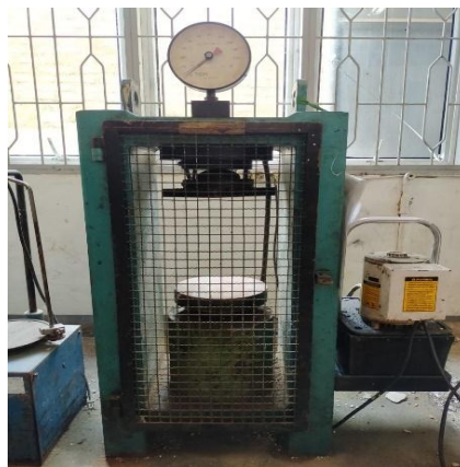
Lampiran 37 : Proses Pengujian Kuat Tarik Belah Beton
