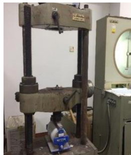
Gambar 3.24: Mesin uji kuat tarik belah beton.
