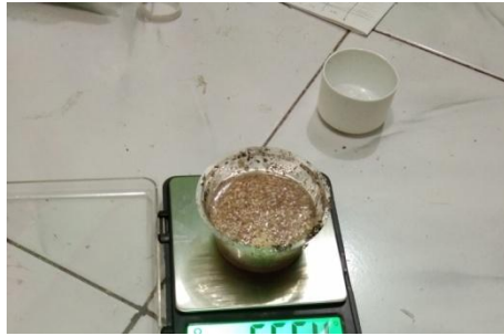
Gambar 3.30. penimbangan berat massa untuk bahan cetakan pipa elbow
