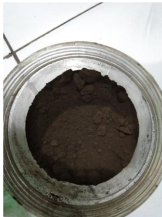
Gambar 3.26. cangkang kelapa sawit yang sudah digiling hingga menjadi serbuk dengan ukuran agregat halus No ayakan 200 dengan ukuran lubang \pm 0,750 mm
