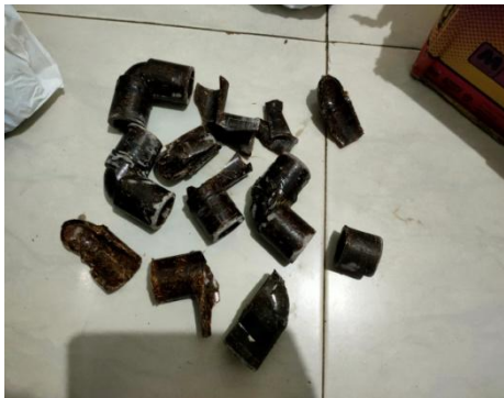
Gambar 3.33. Hasil Pengujian Pipa Elbow
