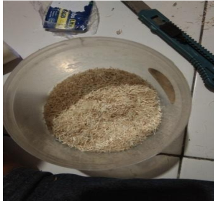
Gambar 3.25. serat tebu yang sudah digunting menjadi serpihan yang berukuran \pm 5 mm
