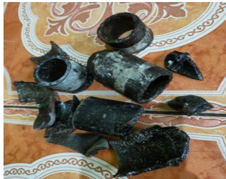
Gambar 3.33. Hasil Pengujian Pipa Elbow
