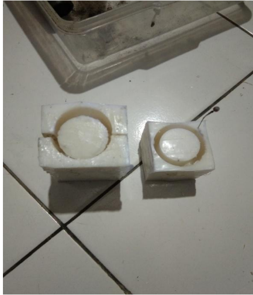
Gambar 3.29. mal cetakan untuk pembuatan pipa elbow
