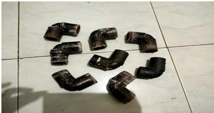
Gambar 3.31. Hasi Pipa yang Terbuat dari Hasil Pemanfaatan Limbah Serat tebu dan cangkang Kelapa sawit
